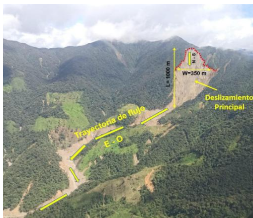
Imagen Nro. 03 Características morfométricas del deslizamiento.
