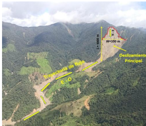
Imagen Nro. 03 Características morfométricas del deslizamiento.
