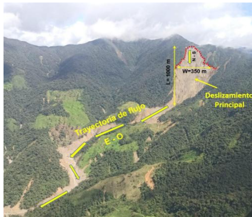
Imagen Nro. 03 Características morfométricas del deslizamiento.
