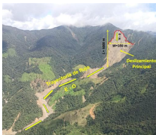
Imagen Nro. 03 Características morfométricas del deslizamiento.
