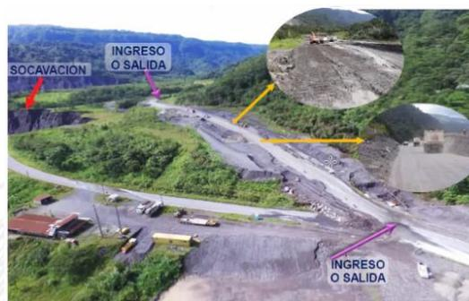
Imagen Nro. 06 Construcción de la variante provisional No. 02
