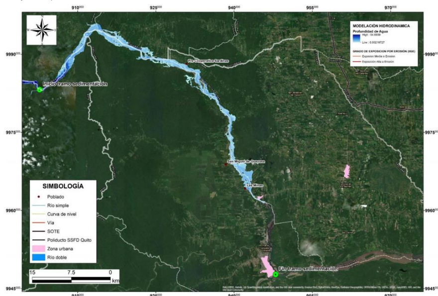
Mapa 2: Modelación hidrodinámica realizada para el tramo fluvial entre la confluencia río Machacuyacu con el Río Coca hasta la confluencia con el Río Napo. Fuente: SNGRE
