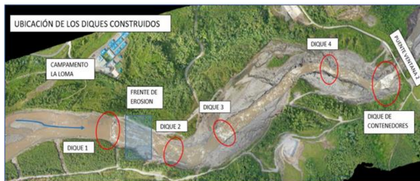
Mapa 1: Diques construidos conformados por contenedores. Fuente: CELEC EP
