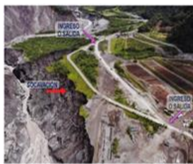
Fotografía 6. Variante provisional de 650 metros en el km. 67.5 habilitada al paso vehicular sin restricciones desde el pasado mes de junio.
