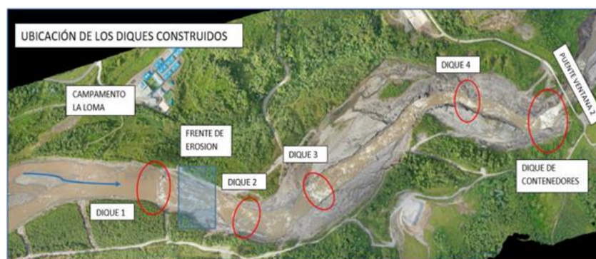
Mapa 2: Diques construidos conformados por contenedores. Fuente: CELEC EP
