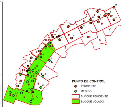
Figura 2. Bloques planificados vs bloques volados en la Etapa 2.
