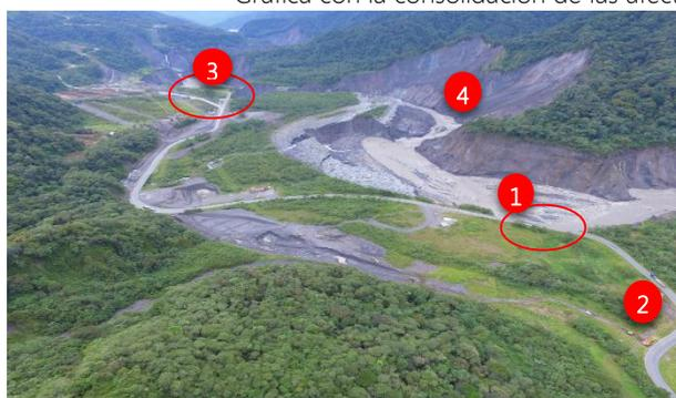
Fotografía 2. Situación vial a causa de la erosión del río – vía Y de Baeza – Lago Agrío. Fuente: MTT3
