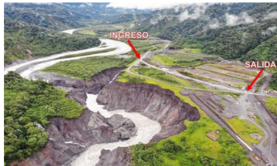
Fotografía 4. Foto aérea de la variante vial con una longitud aproximada de 650 metros
