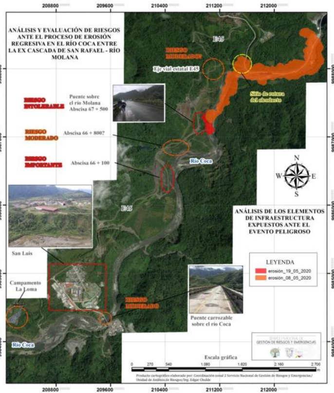
Mapa 2. Evaluación del Riesgo ante el proceso de erosión en el río Coca. Fuente: Ing. Edgar Chulde, Analista de Riesgos CZ2
