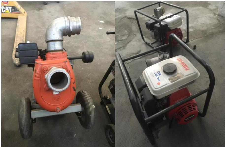
**Foto 2.** Muestra de bombas de succión (motobombas) para mantenimiento
